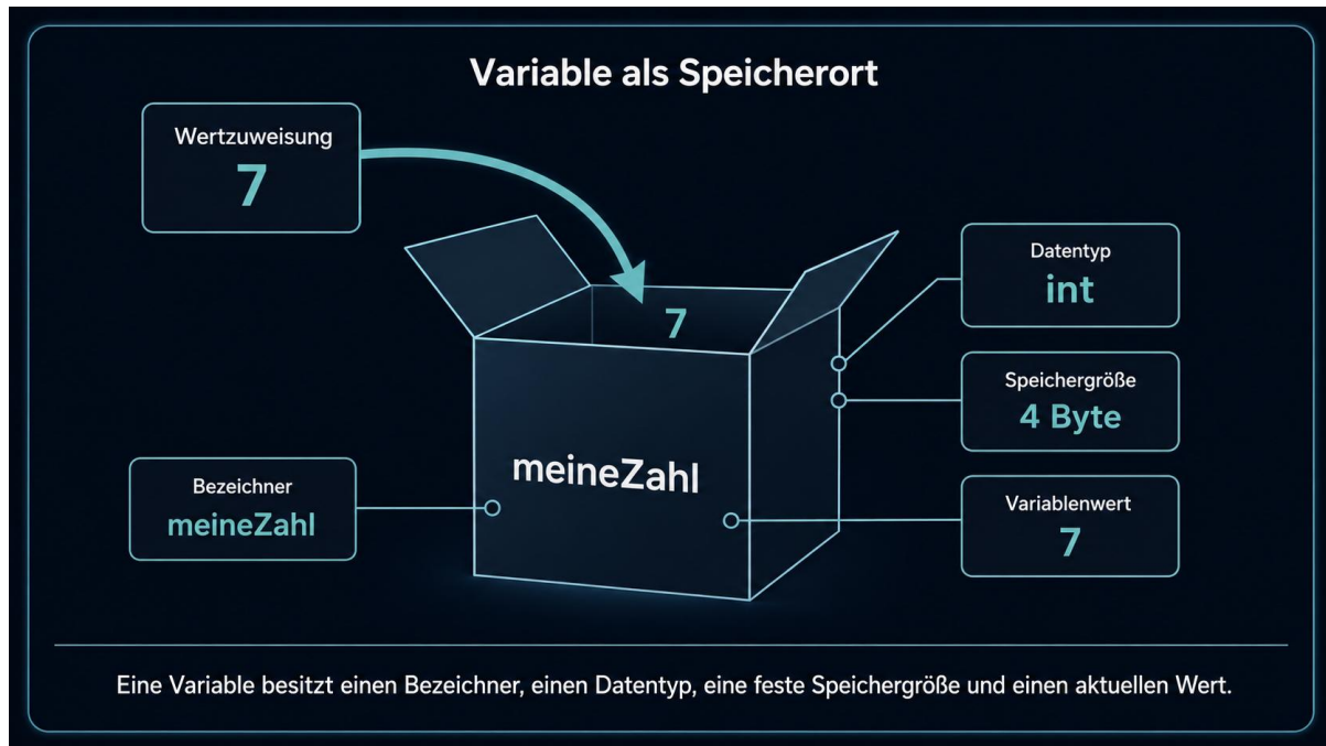
Abbildung 1: Didaktisch begrenztes Bildmodell: Im E3-Kern bestimmen Bezeichner, deklarierter Datentyp und aktueller Wert den Variablenzustand. Speichergröße und konkrete Speicherorganisation sind technische Vertiefungen.
