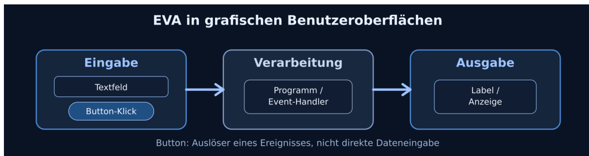
Abbildung 10: EVA im GUI-Kontext: Nutzendeingaben und Klickereignisse werden verarbeitet und in einer Anzeige ausgegeben.
